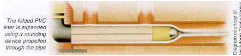
Boru içinde itilen bir yuvarlama cihazı kullanarak, katlı PVC' nin açılması sağlanır.
